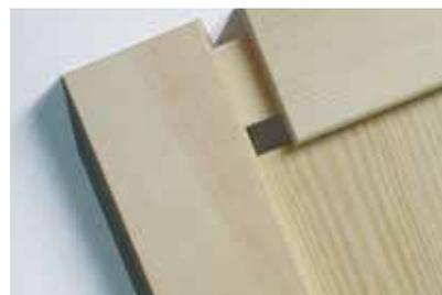
Assemblage par tenon et mortaise
